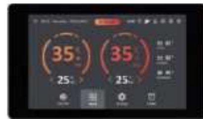
CC1159 TFT屏 TFT Display 外观尺寸 (size) 121*71mm 屏幕尺寸 (Screen size) 4.3 英寸 inches
