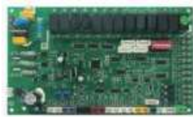
双系统 DOUBLE COMPRESSORS CONTROL
